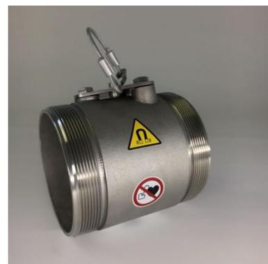
Der MEINERT-Magnetfilter aus Edelstahl (1.4571) wurde entwickelt, um schnell und einfach aus trockenen und gut rieselfähigen Schüttgütern magnetische Eisenverunreinigungen, wie Metallteile, Schrauben, Späne o.ä., zu trennen. Der Magnetfilter wird einfach in die Förderleitung zwischengeschaltet.
