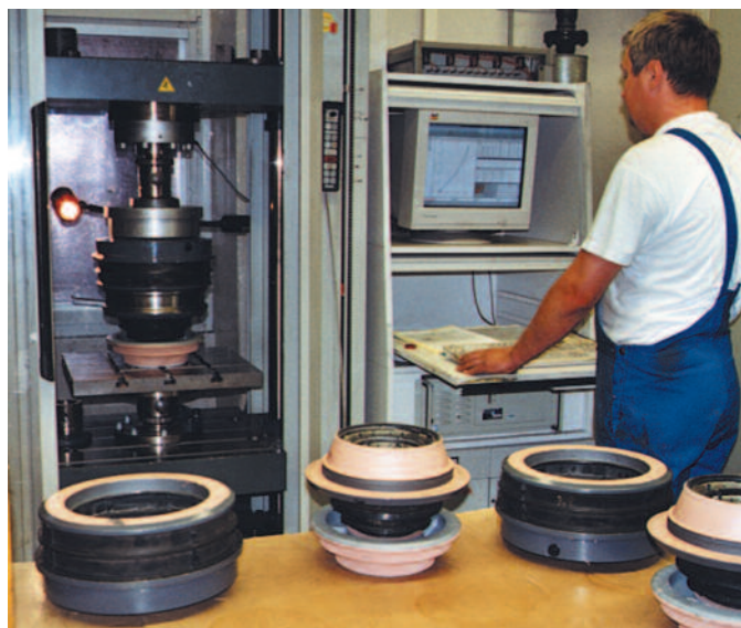
Steifigkeitsmessung an einem MEGI-Bauteil
